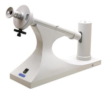
Polarimetro da Laboratorio circolare con sorgente luminosa monocromatica con lampada al Sodio.
