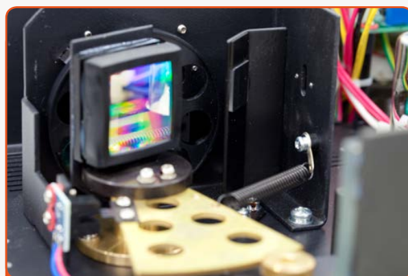
Monocromatore: reticolo da 1200 linee/mm
