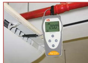
Misura della temperatura in sistemi di condizionamento
