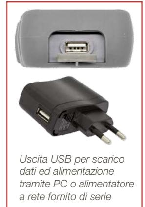
Uscita USB per scarico dati ed alimentazione tramite PC o alimentatore a rete fornito di serie
