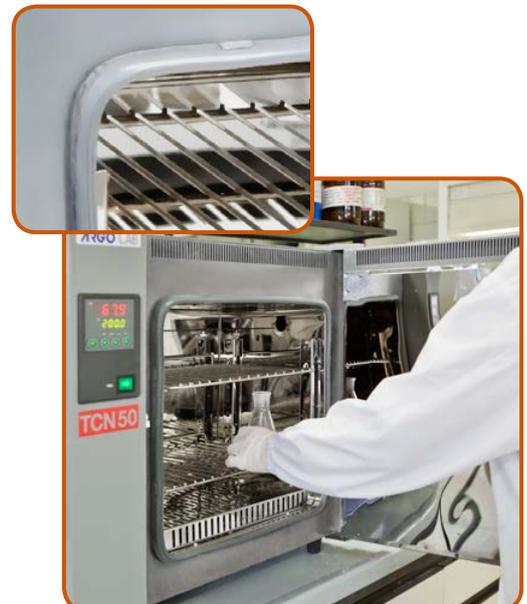
La guarnizione della porta garantisce una perfetta tenuta anche alle temperature più elevate. Le dispersioni di calore sono ridotte al minimo consentendo un'efficiente ciclo di riscaldamento.
