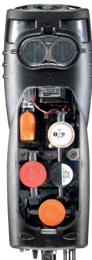
testo 340 consente di selezionare, sostituire e aggiungere, in qualsiasi momento, la cella di misura richiesta. E' possibile scegliere tra le seguenti 7 celle pre-calibrate:
