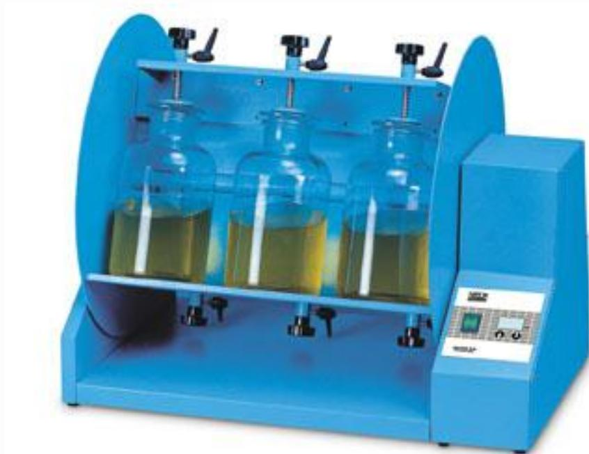
Il mescolatore rotativo ROTAX 6.8 è la soluzione VELP progettata e sviluppata appositamente per la valutazione della solubilità in acqua di sostanze inquinanti, di fanghi, sedimenti e rifiuti solidi da parte di impianti di trattamento rifiuti, impianti di trattamento acque reflue, laboratori di analisi rifiuti, laboratori di analisi ambientali (fanghi, sedimenti).
