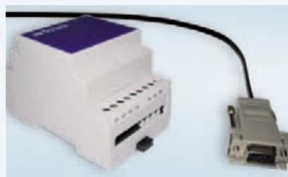
**Convertitore di interfaccia con software di gestione dei dati**
