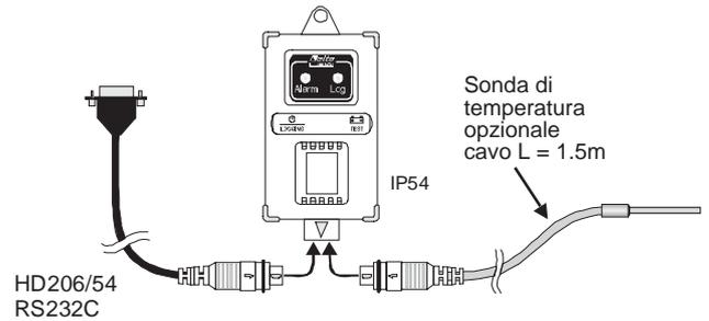
HD206-2 Sonda di temperatura ed umidità relativa
