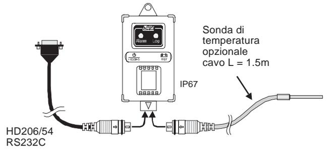
HD207-1 Sensore di temperatura esterno
