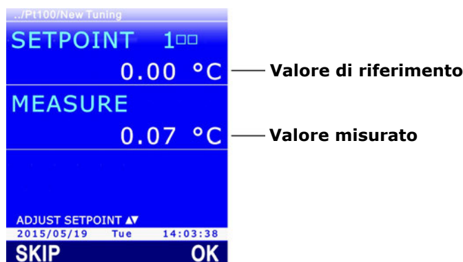
Fig. 13.1.2: calibrazione PRT a 0 °C
