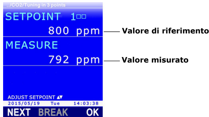
Fig. 13.5.5: calibrazione LINEAR GAINS per sonde CO 2
