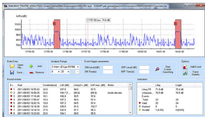
NS2A "Inquinamento Acustico": analisi sulle 24 ore con ricerca automatica dei transiti dei convogli ferroviari.
