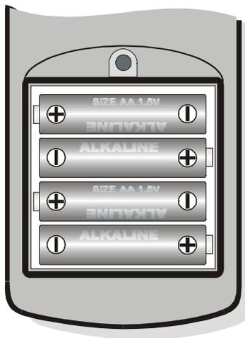
**Dopo il cambio batteria, vanno reimpostati** la data, l'ora, il baud rate, il tipo di sonda, l'intervallo di stampa, i parametri di logging: **per semplificare l'operazione, all'inserimento delle nuove batterie lo strumento si accende automaticamente e richiede di seguito tutti questi parametri.** Per passare da una voce alla successiva premere il tasto ENTER; per tornare in misura, premere MENU.
