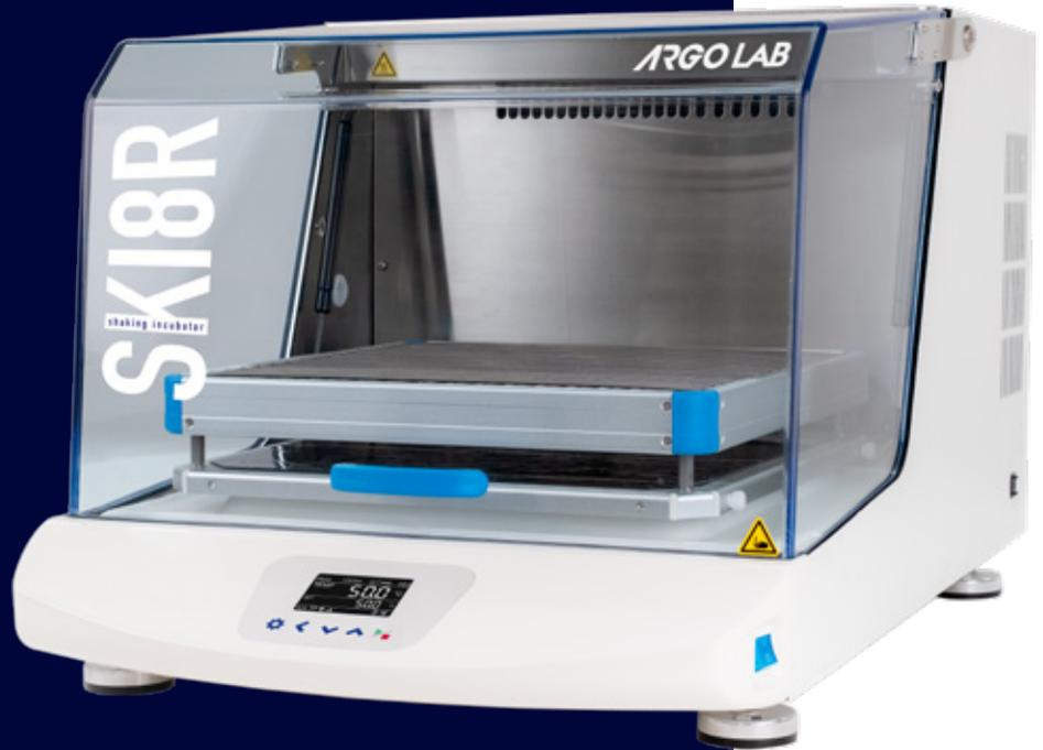
Strumento da banco che combina funzioni di **agitazione e termostatazione in un unico strumento** utilizzato per miscelare liquidi e per incubare colture biologiche.
