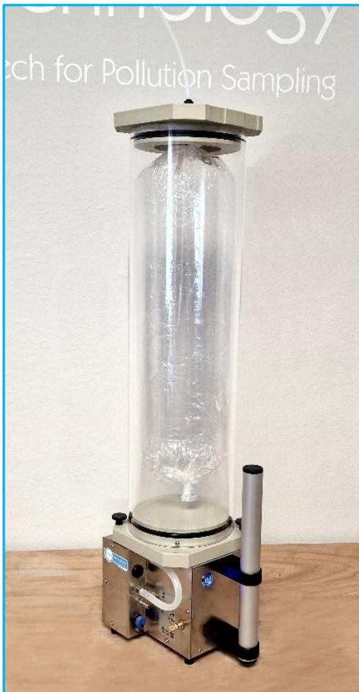
I campionatori a polmone OSP 1.0 - ODOR SAMPLING PUMP [8 LPM] sono atti al campionamento delle emissioni odorigene in conformità con la norma EN 13725:2022.
