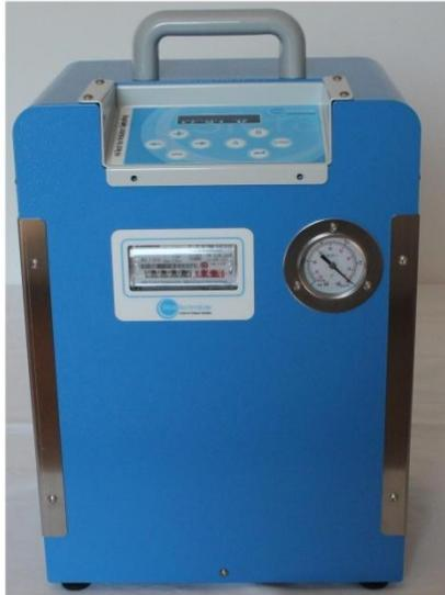
Il campionatore a portata costante modello **GEO Air Plus** è idoneo per campionamenti di polveri e amianto in postazione fissa. Può essere utilizzato anche per campionamenti in emissione.
