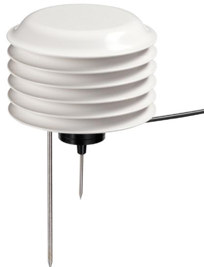
**TP32MTT.03.A:** Sonda con sensore Pt100 a 4 fili per la misura della temperatura del suolo. Con schermo di protezione dalle radiazioni solari. Cavo a 4 poli terminato con fili liberi. Lunghezza del cavo 2, 5 o 10 m.
