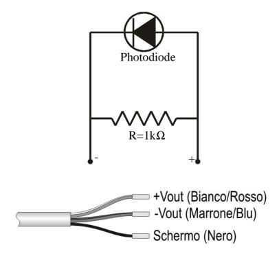
Per ottenere una precisione di lettura dell'1% della differenza di potenziale alle estremità della resistenza, la sonda deve essere collegata a un multimetro digitale con resistenza di ingresso > 100 k $\Omega$ .
