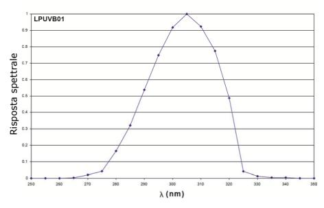
La taratura è eseguita utilizzando la riga di emissione a 313 nm di una lampada a Xe-Hg, filtrata con un idoneo filtro interferenziale. La misura è eseguita per confronto con il campione di prima linea in dotazione al laboratorio metrologico Delta OHM.
