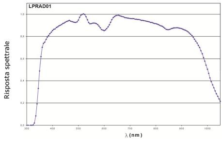
La taratura della sonda è eseguita utilizzando le righe di emissione a 577 nm e 579 nm di una lampada a Xe-Hg e filtrate con un apposito filtro interferenziale. La temperatura ha un'influenza trascurabile sulla risposta spettrale della sonda.
