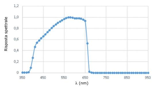
La calibrazione della sonda è eseguita con una lampada alogena di cui è noto l'irradiamento spettrale nella regione spettrale di interesse. (400 nm...700 nm).
