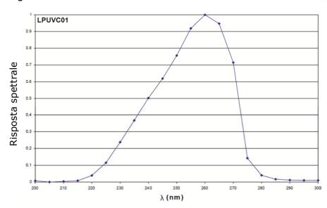
La taratura è eseguita con lampada Hg utilizzando l'emissione a 254 nm.
