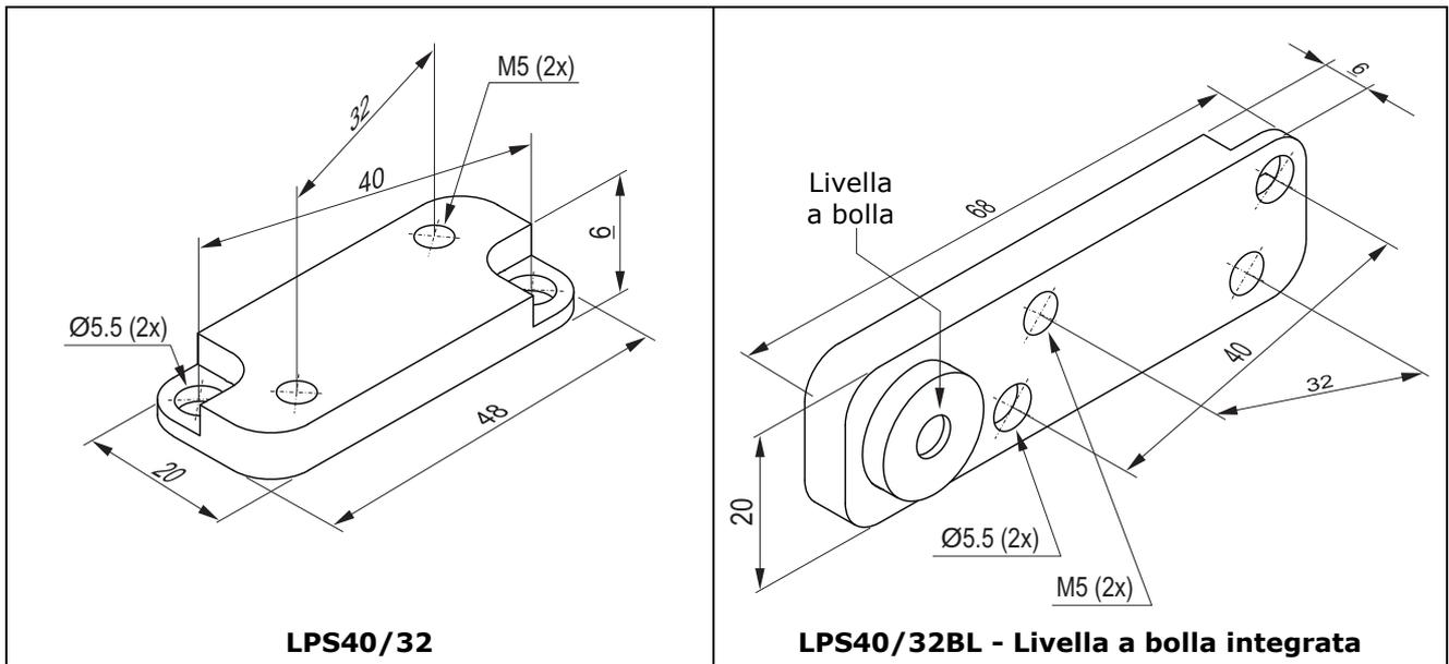
**Fig. 3.2: adattatori di fissaggio da interasse fori 40 a 32 mm**
