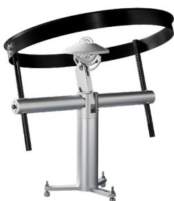
LPPYRA02 è disponibile anche nella **versione con anello di schermo** (LPPYRA12) per la misura dell'irradiamento solare diffuso eliminando il contributo dell'irradiamento diretto
