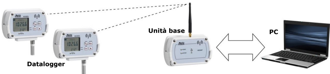
Fig. 2.1: unità base interposta tra i datalogger e il PC
