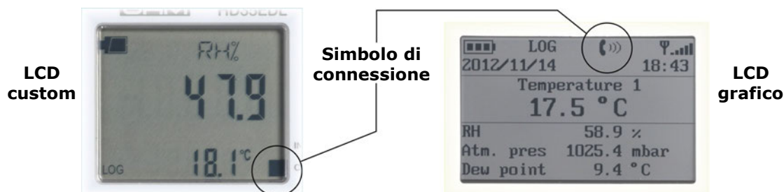
Fig. 3.4: simbolo di connessione nel display
