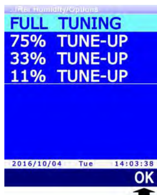
Fig. 13.3.4: tipi di calibrazione del sensore UR
