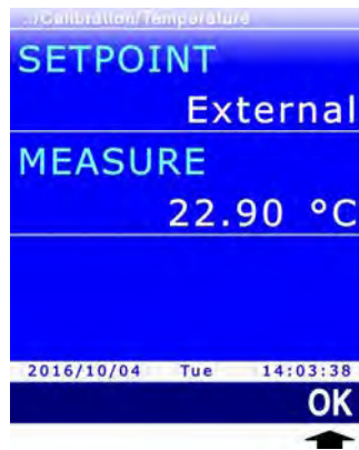
Fig. 13.3.3: calibrazione del sensore Pt100 al valore di riferimento
