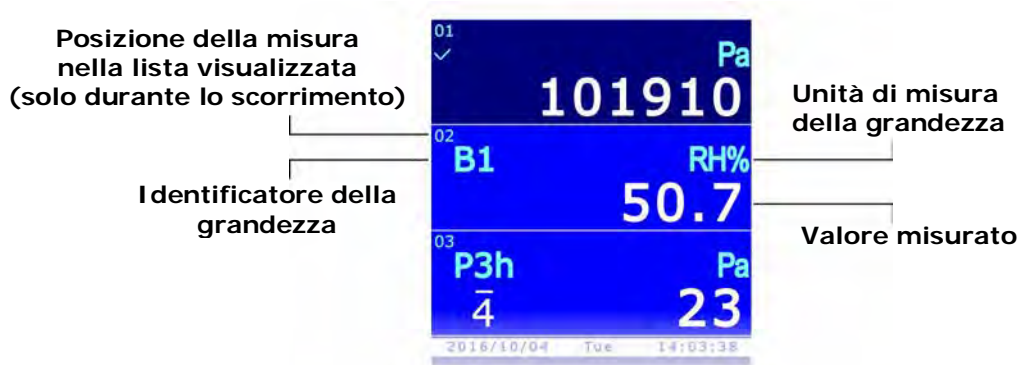
Fig. 3.2: visualizzazione delle misure
