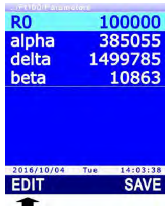
Fig. 13.2.3: parametri dell'equazione per il calcolo della temperatura
