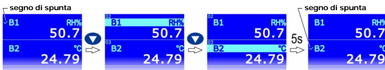
Fig. 3.1.1: selezione di una riga di misura
