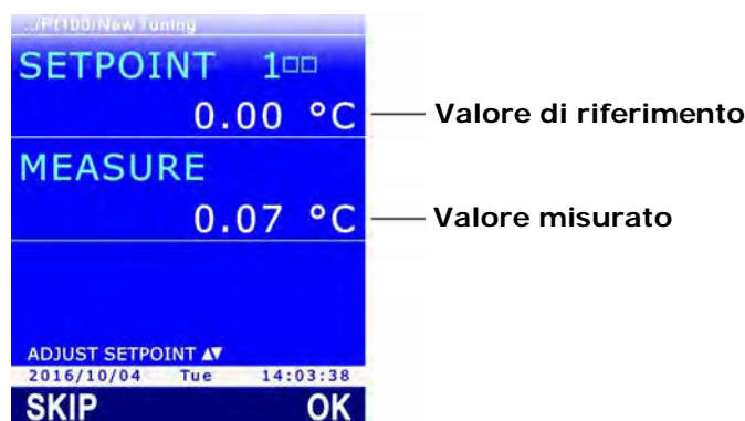
Fig. 13.2.2: calibrazione PRT a 0 °C
