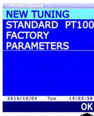
Fig. 13.2.1: tipi di calibrazione delle sonde PRT
