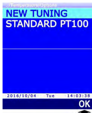
Fig. 13.3.2: tipi di calibrazione del sensore di temperatura
