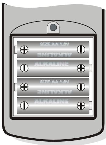
**Dopo il cambio batteria vanno reimpostati** la data, l'ora, il baud rate, il tipo di sonda, l'intervallo di stampa, i parametri di logging: **per semplificare l'operazione, all'inserimento delle nuove batterie lo strumento si accende automaticamente e richiede di seguito tutti questi parametri.** Per
