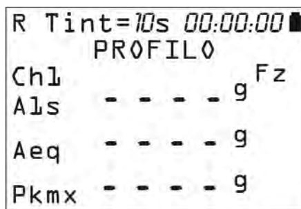
Premendo il tasto START/STOP viene avviato il replay dei dati. Con il tasto MODE si può passare da una schermata all'altra, con il tasto CHN da un canale di misura ad un altro.
