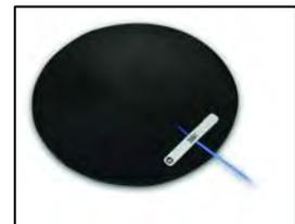
A differenza della misura delle vibrazioni trasmesse al sistema mano-braccio, dove è il modulo dell'accelerazione vettoriale a doversi confrontare con i limiti di legge, nella misura delle vibrazioni al corpo intero il confronto avviene con la **componente dominante**, cioè quella lungo l'asse di maggiore sollecitazione. E' pertanto necessario orientare accuratamente gli assi dell'accelerometro secondo il sistema di riferimento stabilito
