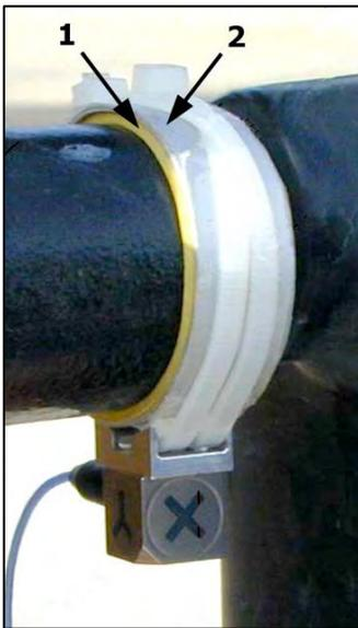
Per evitare che questo fenomeno, denominato "DC shift", si presenti occorre ridurre le sollecitazioni dell'accelerometro alle alte frequenze. Normalmente, la presenza di materiale resiliente sull'impugnatura dell'utensile oppure l'interposizione di un sottile strato di 1-2 mm di gomma tra il supporto dell'accelerometro e l'impugnatura, sono sufficienti ad evitare la comparsa del fenomeno (1 nella figura a fianco).
