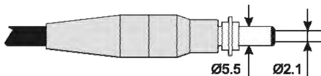
Richiede un alimentatore in corrente continua di 9...12Vdc/300mA.
