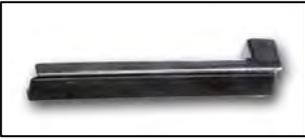
L'HD2030AC2 è costruito in lega leggera e si utilizza con accelerometri dotati di foro filettato (10-32 UNF oppure 5-40 UNC) che vengono fissati sull'adattatore mediante una apposita vite.
