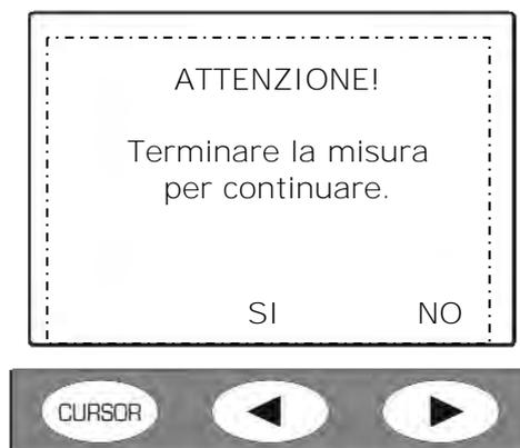
Premendo SI lo strumento va in modalità STOP ed è possibile procedere con la modifica del parametro selezionato.
