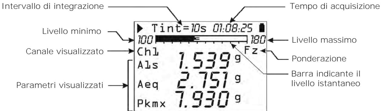
Le schermate VLM presentano, in forma numerica, tre parametri ponderati in frequenza relativi a ciascuno dei tre canali di misura oppure al vettore accelerazione calcolato sui tre assi. **E' possibile passare in sequenza le schermate usando i tasti cursore destro e sinistro.** La barra orizzontale visualizza i livelli istantanei dei tre canali di misura espressi in dB.
