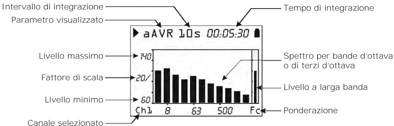
La schermata SPETTRO presenta in forma grafica lo spettro per bande d'ottava o di terzo d'ottava relativo a ciascuno dei 3 canali di misura. **L'ordine dello spettro visualizzato**, per bande d'ottava o di terzo d'ottava, è impostabile accedendo a Menu >> Impostazioni >> Analizzatore di spettro >> Ordine.
