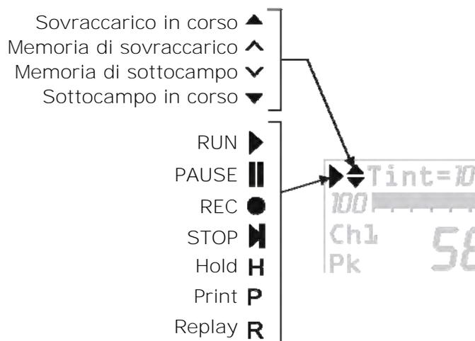
Il primo simbolo posto nell'angolo in alto a sinistra del display indica lo **stato di acquisizione** del vibrometro.
