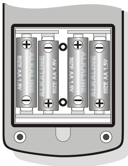
In alternativa alle batterie alcaline è possibile utilizzare batterie ricaricabili di tipo NiMH. Affinché lo strumento possa gestire correttamente il livello di carica delle batterie, è necessario selezionare nel menu il tipo di batterie utilizzate (tasto MENU >> Impostazioni >> Generale >> Sistema >> Batteria = NiMH oppure Alkaline).
