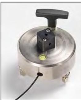
*Supporto adatto per le misure su pavimenti e altre superfici vibranti. Sono previsti tre diversi punti di fissaggio:*
