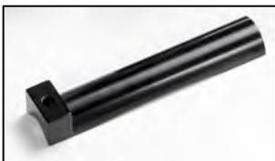
HD2030AC2 ed HD2030AC3 sono adattatori da stringere tra la mano e l'impugnatura. Dato che l'accelerometro viene fissato in posizione laterale, la misura deve essere ripetuta posizionando l'accelerometro da entrambi i lati della mano.
