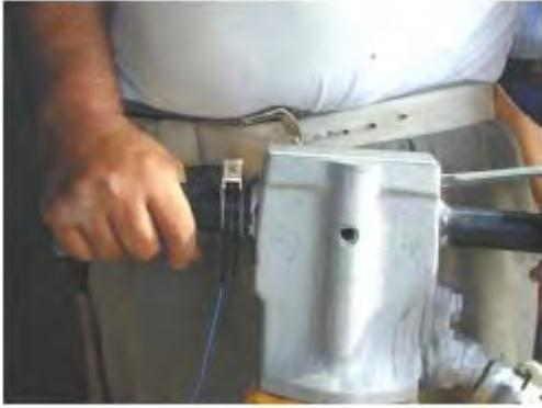
In alcuni casi, per la particolare sagoma delle impugnature o per l'ingombro dovuto alla leva di comando, non è possibile fissare l'accelerometro secondo le indicazioni della norma. In questo caso si cercherà una posizione alternativa in posizione la più prossima possibile alla mano dell'operatore.
