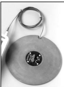
Per la misura delle vibrazioni trasmesse dai sedili e dagli schienali l'accelerometro viene normalmente inserito in un pad in gomma conforme alle prescrizioni della norma UNI EN 30326-1. Questo pad viene fissato sul sedile o sullo schienale con del nastro in modo da interporre tra il sedile stesso ed la parte del corpo che riceve le vibrazioni.
