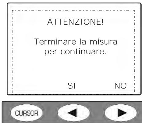
Premendo SI lo strumento va in modalità STOP ed è possibile spegnere lo strumento con il tasto ON/OFF.
