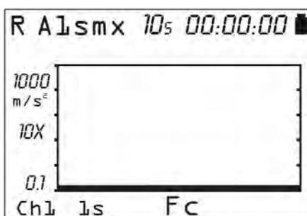
Alla pressione del tasto START, il profilo viene riprodotto in automatico. È possibile passare da un canale di misura ad un altro con il tasto CHN ma non vi sono altre schermate attive in quanto questa modalità registra solo l'andamento del profilo temporale dei tre canali.
