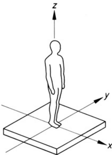
La norma definisce i sistemi di coordinate per la misura delle accelerazioni mantenendo gli assi x,y e z sempre diretti nello stesso verso ma con origine diversa, a secondo che la posizione dell'operatore sia seduta, in piedi o sdraiata. Nelle vibrazioni al corpo intero l'asse z, che è diretto nel verso della colonna vertebrale, rappresenta l'organo maggiormente a rischio per l'esposizione a vibrazioni.
