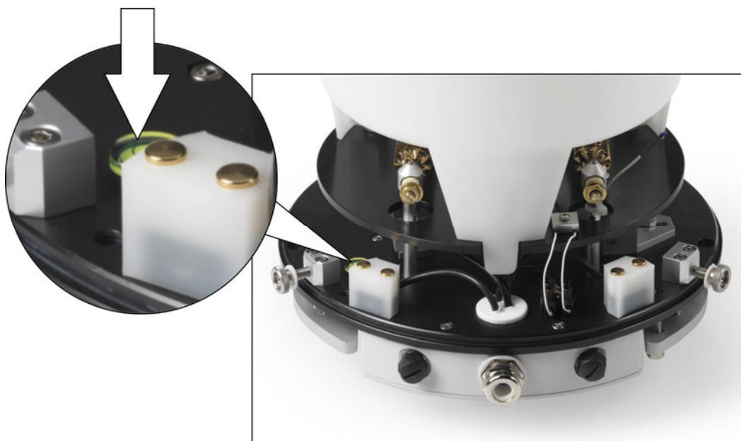
Fig. 3.7.1: localizzazione della livella a bolla
