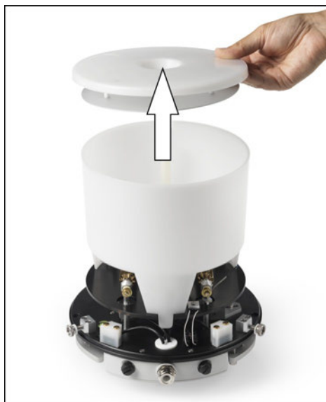
Fig. 9.3: contenitore di raccolta della precipitazione
