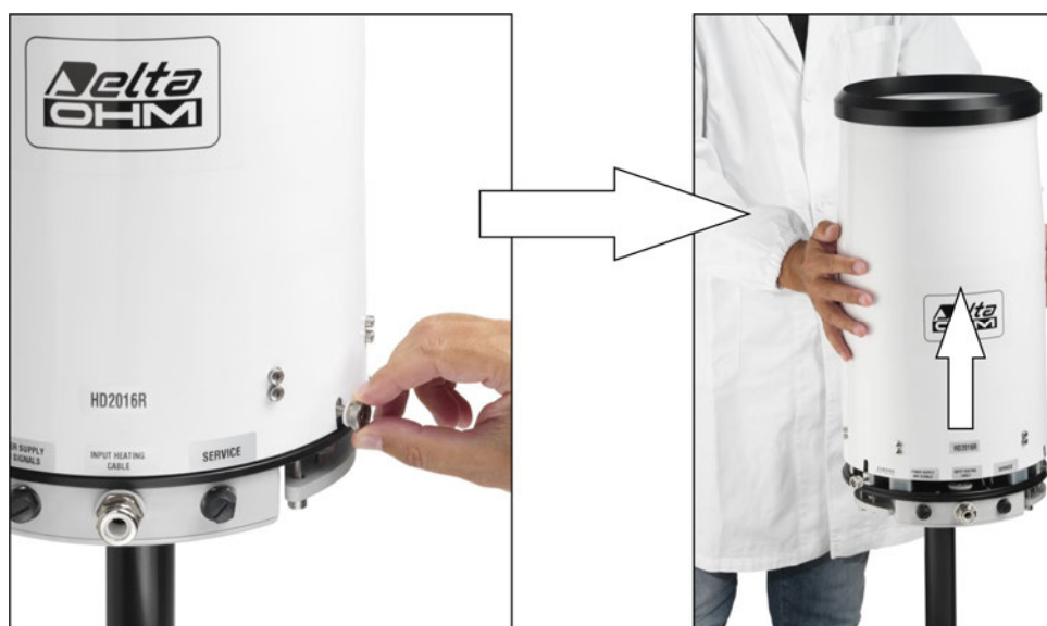
Fig. 9.2: rimozione del mantello
