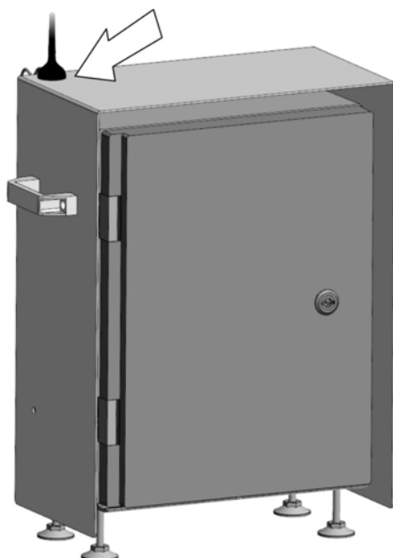
Posizione antenna 3G
