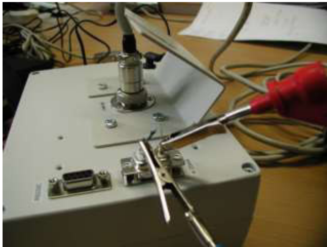
Esempio di prova dell'interfaccia 4 -20mA con la resistenza R_{we} < 5100
