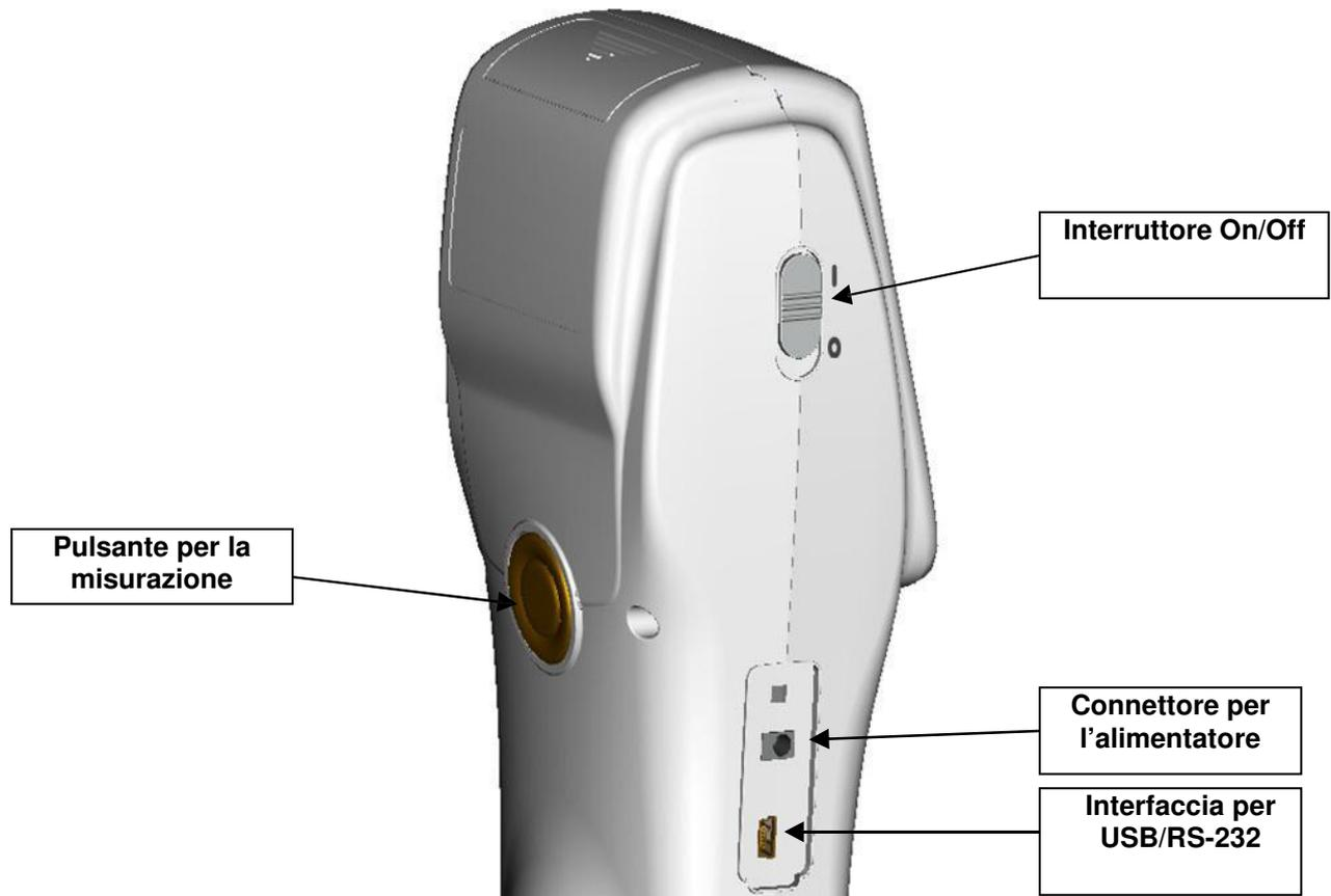
Fig. 1: Interfaccia / Connettore
