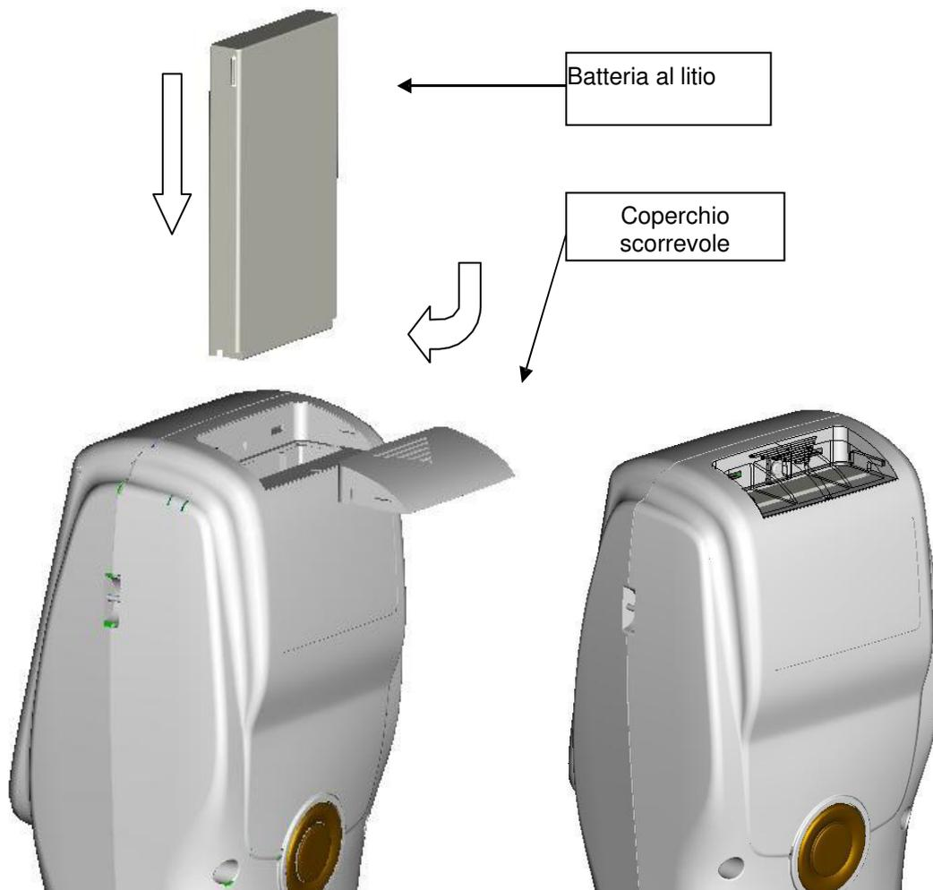
Fig. 2: Installazione della batteria
