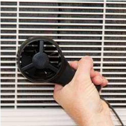
Qui può vedere l'anemometro PCE-VA 10 mentre misura un sistema di ventilazione.
