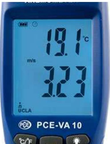
Il display retroilluminato dell'anemometro PCE-VA 10 permette una facile lettura dei valori, anche in condizioni di scarsa illuminazione.
