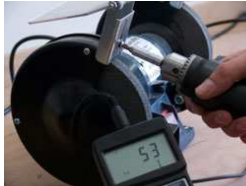
I valori determinati si possono leggere direttamente nel display del misuratore di torsione
