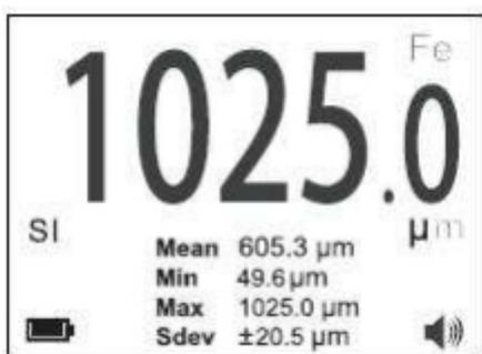
Quando la misurazione è fuori dei limiti stabiliti di allarme, il dispositivo emette tre «bip».
