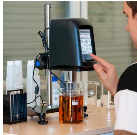
**Viscosimetro di precisione con display touch screen / Sensore di temperatura / Supporto da laboratorio / Range di misura fino a 2.000.000 mPa\*s / 5 mandrini differenti / Misurazione della viscosità nei liquidi / Interfaccia RS-232**
