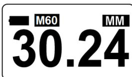
5. Prima di effettuare un'altra misurazione, sollevare la sonda in aria fino a quando il nome della sonda non è più evidenziato in nero, il che significa che lo strumento è pronto.
