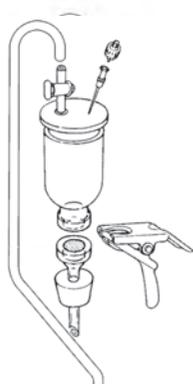
Dispositivo filtrante completamente assemblato per effettuare test di sterilità con antibiotici o prodotti farmaceutici.
