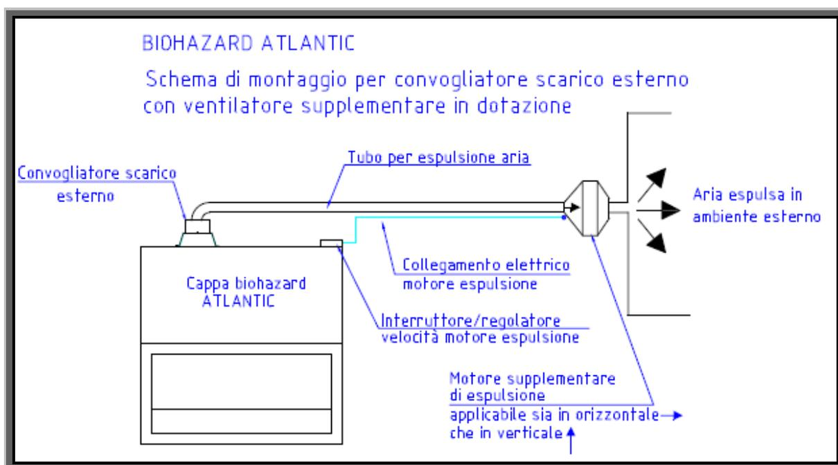
Fissare il ventilatore supplementare di espulsione alla parete, così che il condotto di uscita risulti sempre in aspirazione. Questo permette la fuoriuscita del flusso d'aria espulso dalla cappa anche in caso di perdite del condotto.
