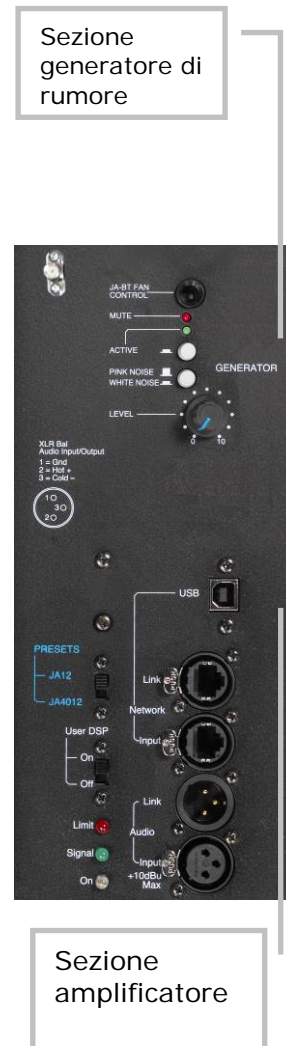
Fig. 2 – Pannello della sezione generatore (in alto) e della sezione amplificatore (in basso)
