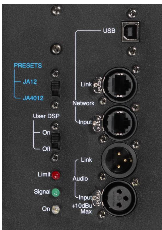
Fig. 4 – Sezione PRESETS, User DSP e connettori dell'amplificatore
