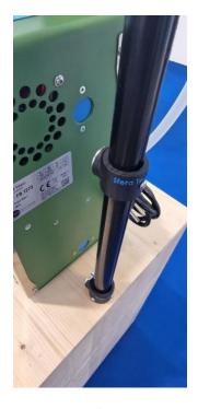
Tramite 2 magneti è possibile applicare velocemente l'asta telescopica per alloggiare il supporto con pinza dove collegare la cassetta precaricata con il filtro di campionamento.
