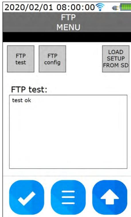
La configurazione della connessione FTP può essere inserita utilizzando la tastiera virtuale dello strumento oppure è possibile caricare la configurazione da un file di testo presente nella memoria dello strumento.
