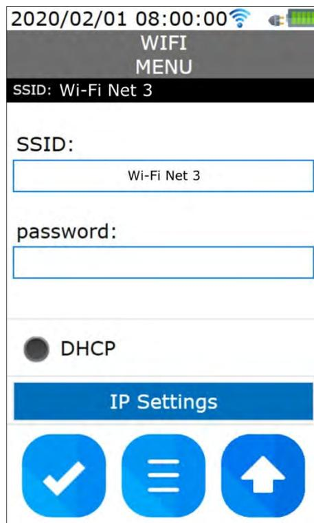
Selezionare DHCP (Dynamic Host Configuration Protocol) per ottenere automaticamente un indirizzo IP dinamico dalla rete. Dopo la connessione, l'indirizzo dinamico assegnato dalla rete allo strumento è visibile premendo "IP Settings". Per inserire un indirizzo IP statico manualmente, de-selezionare DHCP e premere "IP Settings", quindi configurare l'indirizzo e confermare premendo il tasto "spunta".
