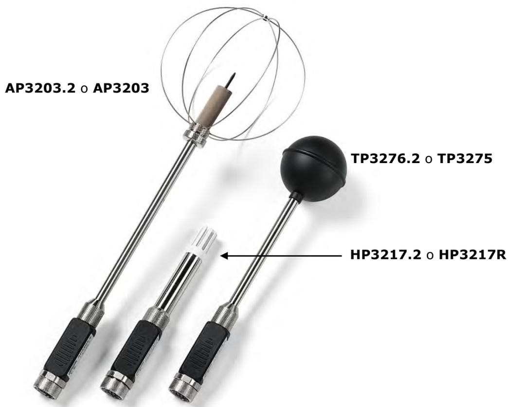
Le sonde sono già calibrate di fabbrica. I dati di calibrazione sono conservati nella memoria del modulo SICRAM.
