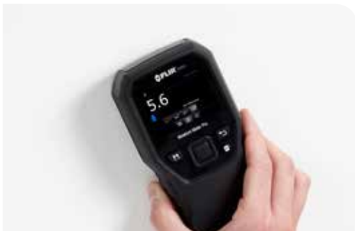
Verifica dell'umidità con misurazione senza puntali
