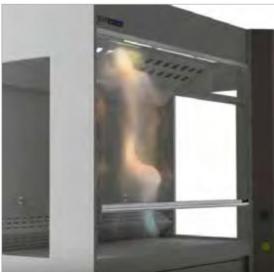
Il sistema RMP può essere regolato per le velocità richieste dall'operatore, anche in un secondo tempo in pochi secondi, per avere velocità di aspirazione da 0,3 a 0,7 m/s.
