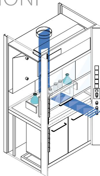
Per il posizionamento di piccoli accessori (flaconi - bicchieri- contenitori, ecc.) all'interno della cappa utilizzare una scaffalatura rialzata che permetta il passaggio dell'aria e non ne disturbi il flusso.
