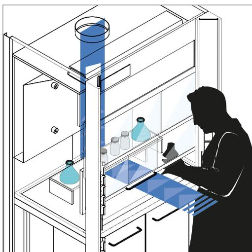
La posizione dell'operatore di fronte alla cappa influenza molto la capacità di aspirazione della stessa.
