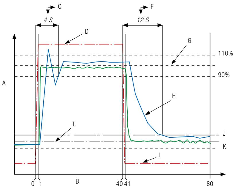
Nel diagramma si può vedere, con il tratto blu, l'andamento della portata variabile (V.A.V) classico con valvola motorizzata o inverter.
