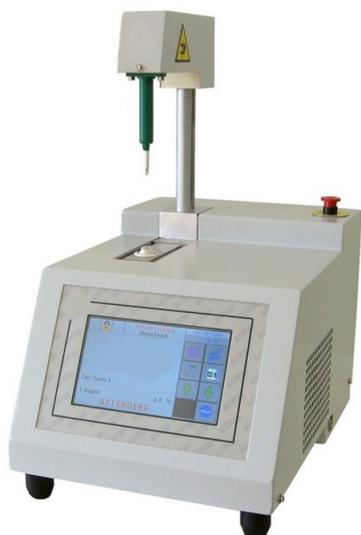
L'osmometro OsmoTouch 1 è uno strumento automatico per l'analisi dell'osmolalità in soluzioni farmaceutiche e liquidi biologici mediante il principio della determinazione del punto di congelamento del campione (*punto crioscopico*).
