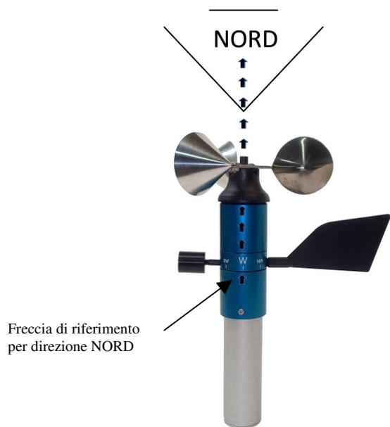
**FIG 3 - Posizione corretta di lettura (Direzione del Vento) pag. 6**
