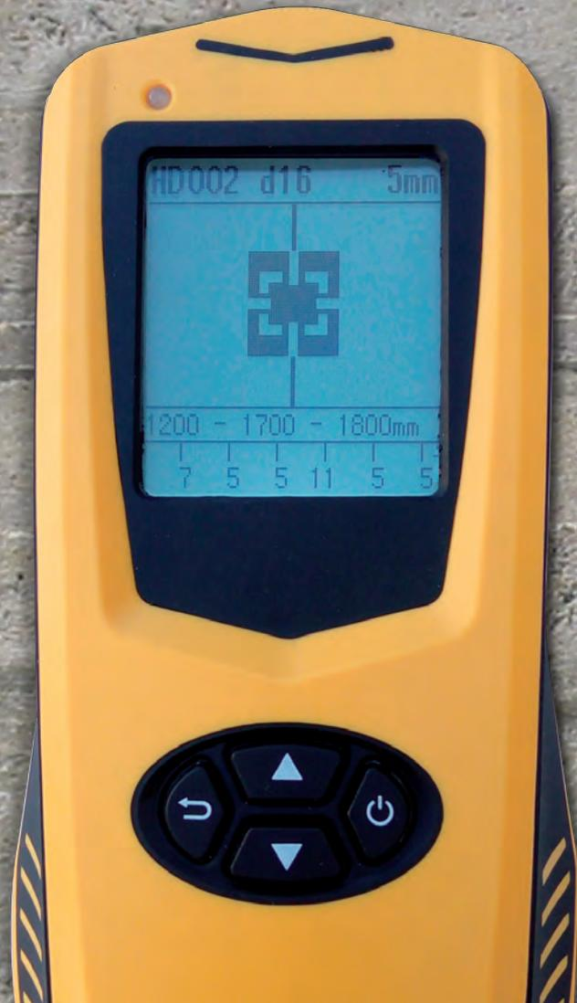
Il pacometro TECNIX PaCo è uno strumento che permette di rilevare in maniera non distruttiva la presenza, la direzione e il diametro delle barre di armatura all'interno di elementi in calcestruzzo armato inoltre consente la misura dello spessore del copriferro e l'interfero.
