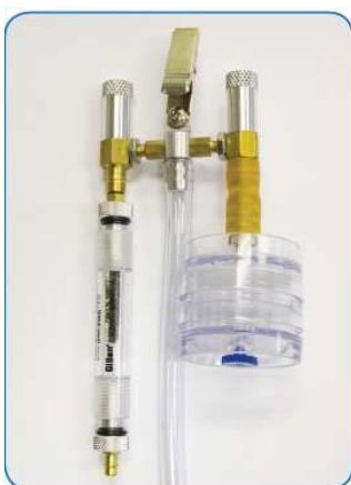
Mod. con ingresso dal basso cod. 505396 Esempio di configurazione con 1 portafiala e 1 filtro a cassetta
