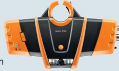
Analizzatore di combustione testo 330i con sensori gas di lunga durata (fino a 6 anni), con sensori O<sub>2</sub> e CO, diluizione per sensore CO, calibrazione celle con sonda già inserita nel canale fumi, Bluetooth, batteria ricaricabile e certificato di taratura
