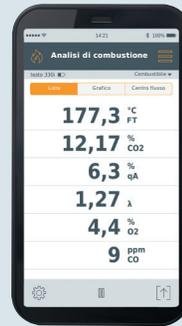
Il funzionamento dello strumento di misura e la visualizzazione dei valori misurati avvengono via bluetooth grazie alla app testo 330i installata sul vostro smartphone o tablet – indipendentemente dalla locazione di misura. Inoltre, potete usare la app per creare report di misura, aggiungervi foto e commenti e inviarli via e-mail. Per iOS e Android.
