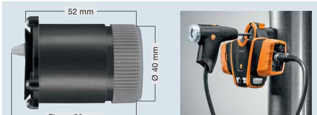
Per fori di misura a partire da 10 mm di diametro e con un diametro sonda di 8 mm
