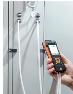
Il modello testo 440 dP con sensore della pressione differenziale vi permette di controllare se i filtri dell'impianto di condizionamento funzionano correttamente, evitando che le particelle dannose contenute nell'aria esterna entrino nel locale.
