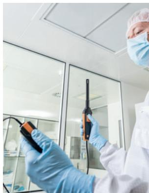
Dovete misurare anche in ambienti dove non è possibile/ammesso l'uso di Bluetooth? Nessun problema: basta scollegare il puntale dall'impugnatura Bluetooth e collegarlo all'impugnatura con cavo.
