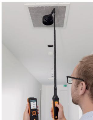
La sonda a mulinello 100 mm può essere comodamente collegata alla squadra da 90° più telescopio, facilitando così le misure in prossimità degli scarichi nel soffitto.
