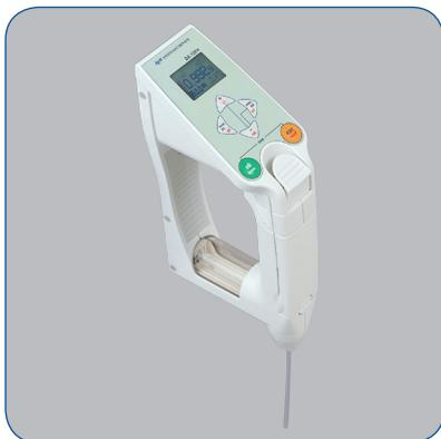
Per la misura della densità (basata sul principio del capillare oscillante) e delle misure correlate (Alcol 20°C, API tavole A/B/D, Salinità, H2SO4, Plato, Brix, ecc.)
