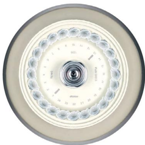
Vista all'interno della centrifuga (rotore 1226)
