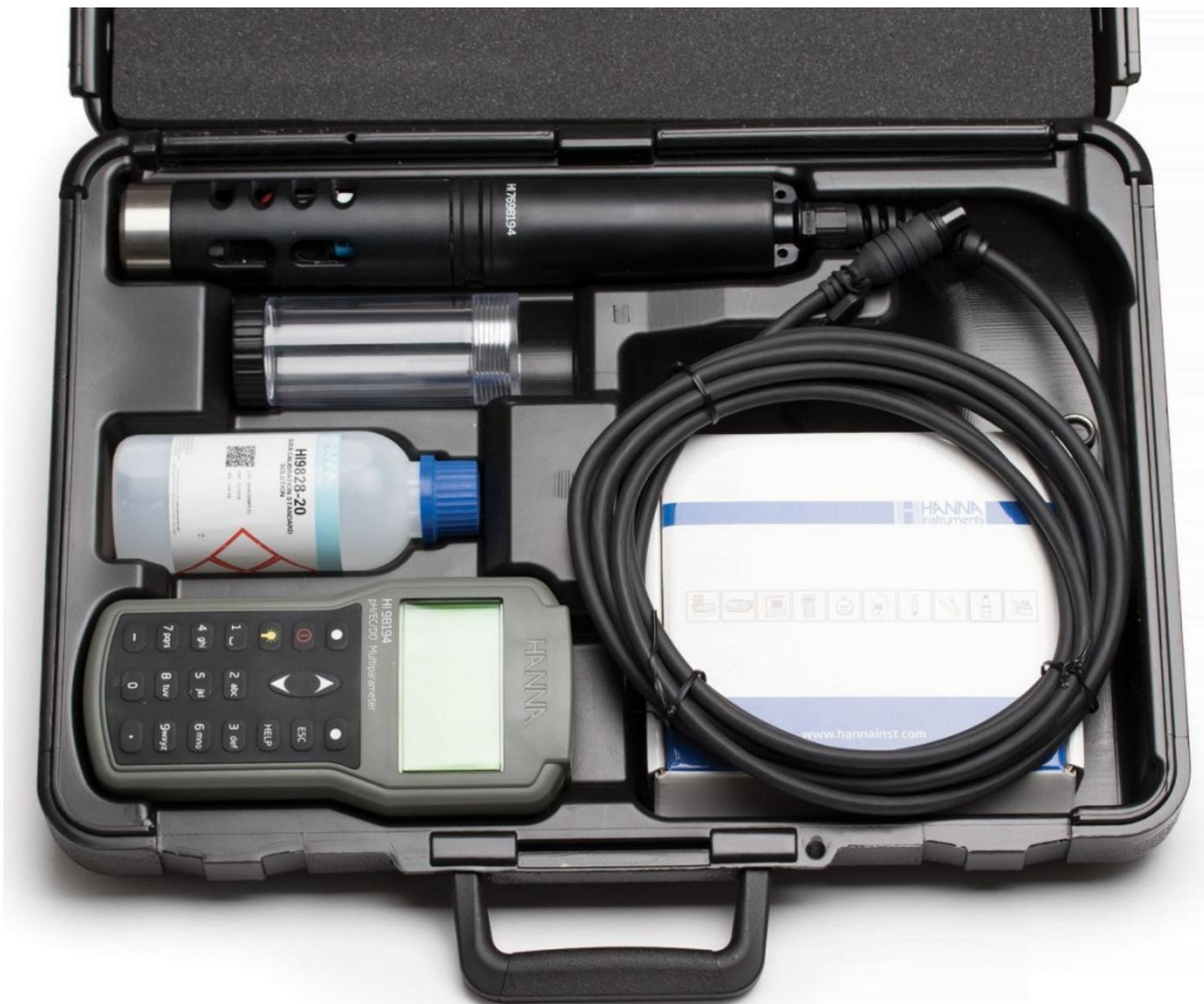
Lo strumento HI98194, la sonda, i sensori e tutti gli accessori sono forniti in una valigetta rigida progettata per garantire anni di utilizzo. Il vano interno della valigetta è in plastica termoformata, per contenere saldamente e proteggere tutti i componenti.
