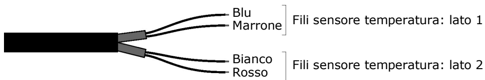
Fig. 6: Connessione sonde TP32MTT.03.A e TP32MTT.03.C
