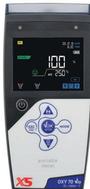
Con **solo 6 tasti** è possibile gestire facilmente le numerose funzioni dello strumento.
