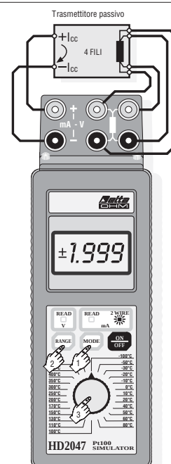
Fig. 3 Verifica di un trasmettitore passivo con ingresso Pt100
